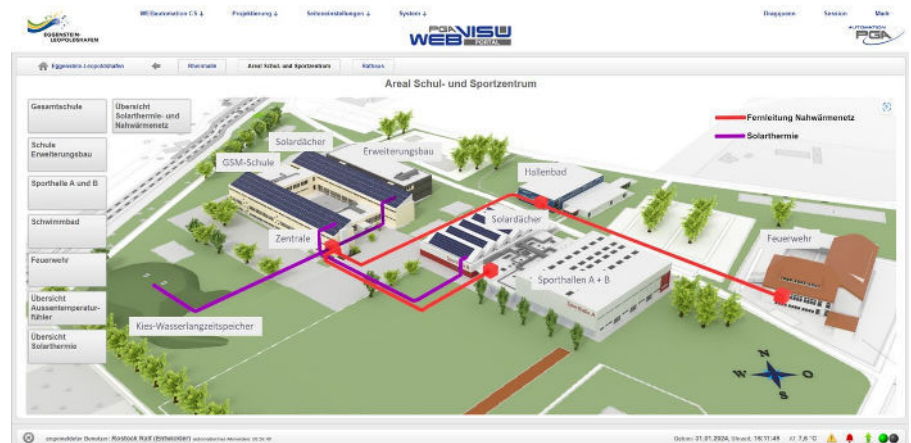
Übersicht des Schul- und Sportzentrums im OAS WEBvisuPORTAL. Overview of the school and sports center in the OAS WEBvisuPORTAL. © OAS
