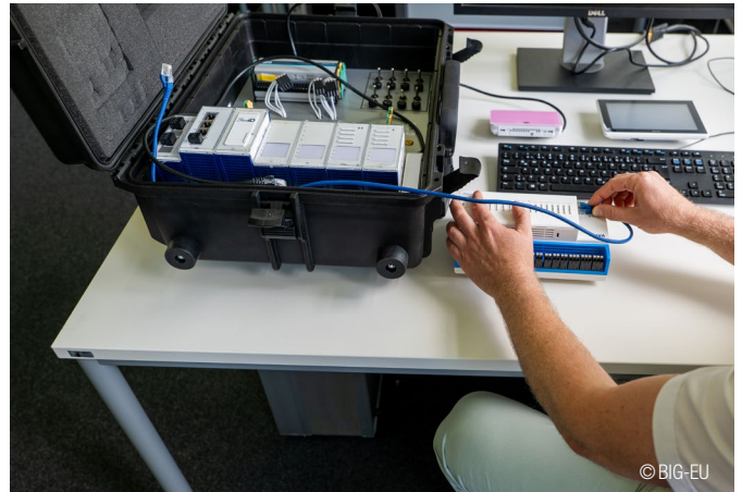
Anschluss eines TP-Kabels zur Datenübertragung im Labor der FH Aachen. Connection of a TP cable for data transmission in the FH Aachen laboratory.
